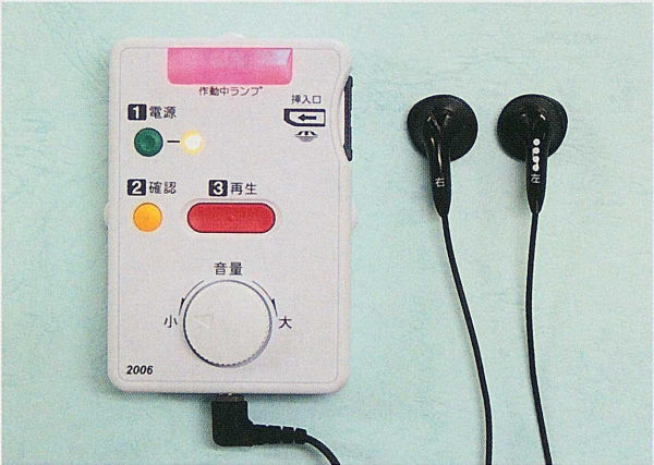
ICプレーヤーには3つのボタンと2つのランプ、音量調節つまみが付いています。2つのランプ(赤、黄緑)はICプレーヤーの作動状態を示します。
