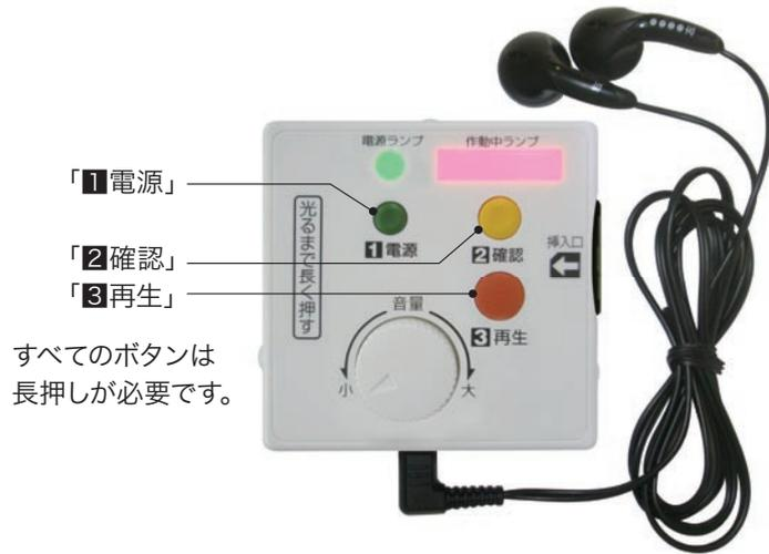
ICプレーヤーには、3つのボタンと2つのランプ、音量調節つまみが付いています。2つのランプ（緑、赤）はICプレーヤーの作動状態を示します。
