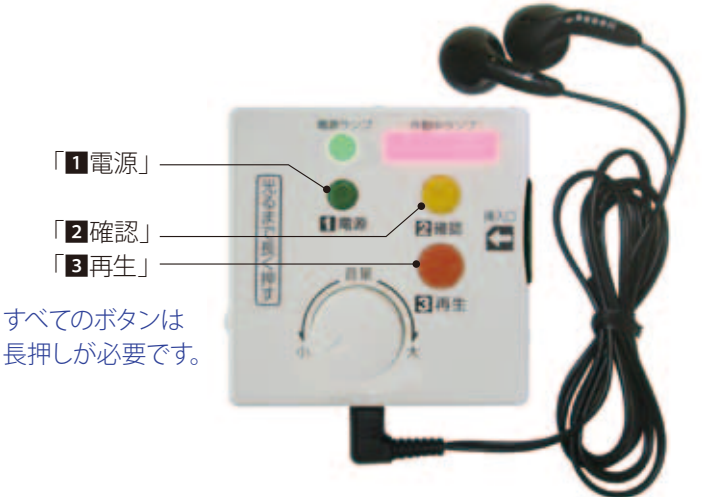
ICプレーヤーには、3つのボタンと2つのランプ、音量つまみが付いています。2つのランプ(緑、赤)はICプレーヤーの作動状態を示します。
