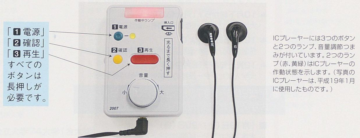
ICプレーヤーには3つのボタンと2つのランプ、音量調節つまみが付いています。2つのランプ(赤、黄緑)はICプレーヤーの作動状態を示します。(写真的ICプレーヤーは、平成19年1月に使用したものです。)
