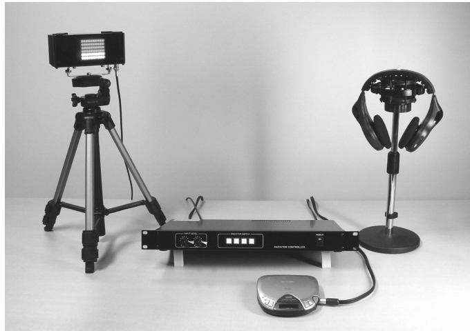
図 1 赤外線音声伝送装置の構成 中央手前：携帯型 CD プレーヤー，中央：ラジエータ・コントローラー，左：赤外線ラジエータ（LED 光は肉眼では見えない），右：赤外線ワイヤレスヘッドホン
