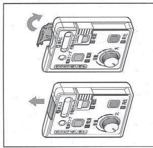
**③** 音声メモリーを袋から取り出す。ICプレーヤー表面が見えるようにした状態で、矢印の面を表にして、奥に突き当たるまでしっかりと差し込む。
