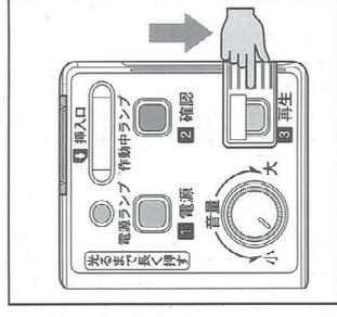
イヤホンの左右を確認してから、耳に付け、②の「確認ボタン」を、「作動中ランプ」が光るまで長く押し続ける。
